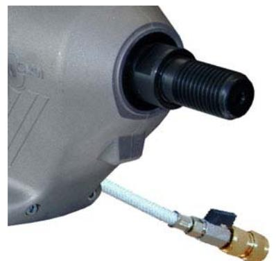
Отрегулируйте поток воды с помощью регулировочного крана. Примерные рекомендации по минимально необходимому потоку воды в зависимости от диаметра сверления – следующие:
