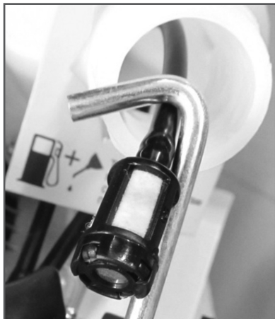
Рис.13 Обслуживание топливного фильтра
